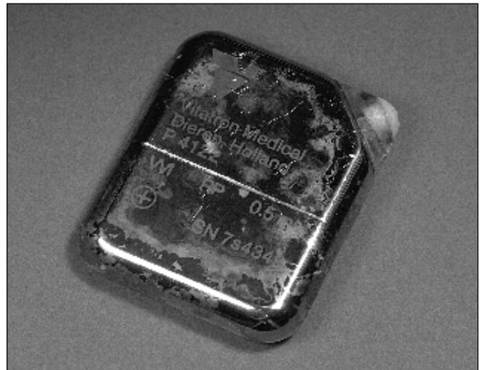
Fig. 5 Conexión holandesa Vitatron sin conector
