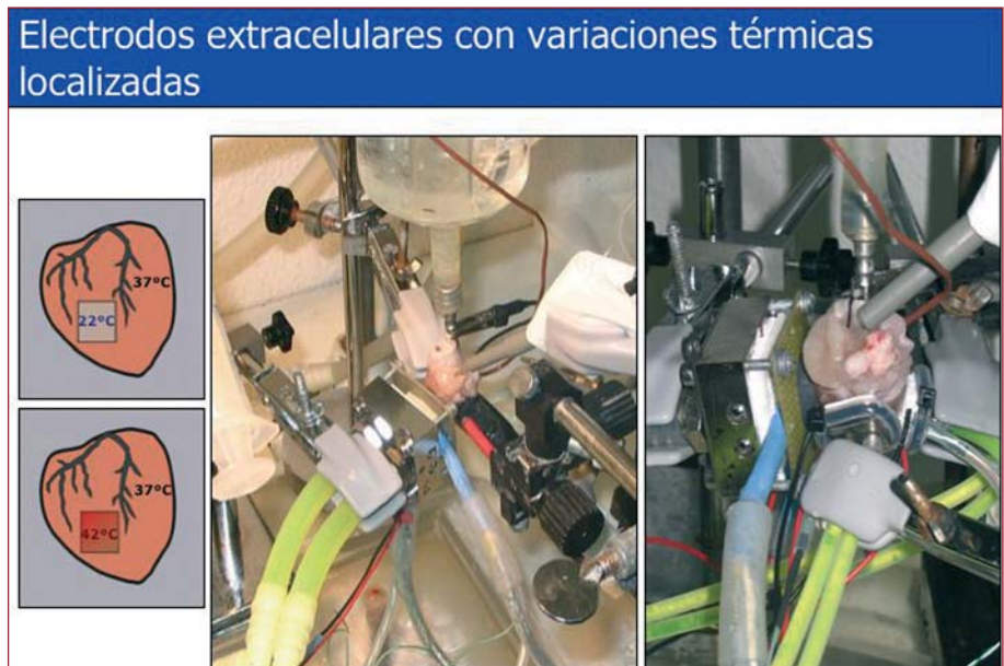
Fig. 6. Dispositivos utilizados para efectuar estudios cartográficos de la actividad eléctrica cardiaca introduciendo variaciones térmicas localizadas en el corazón aislado y perfundido de conejo.
