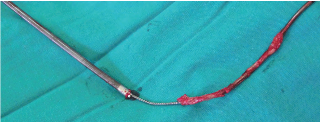
Figura 8.- Detalle de un cable extraído con retracción del aislante y conductor helicoidal visible.
