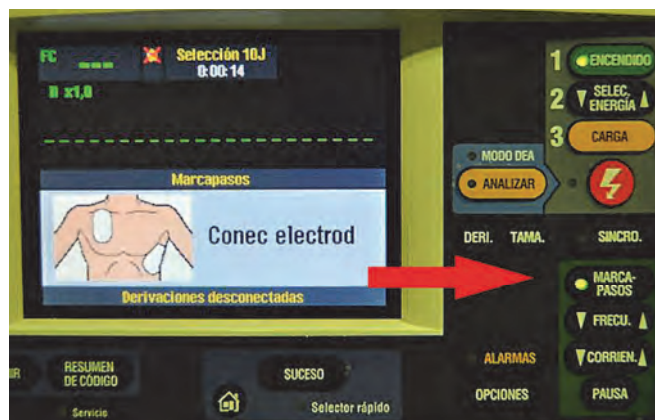
Figura 3. Desfibrilador con marcapasos transcutáneo: La opción de marcapasos puede usarse en modo demanda (sincrónico) o fijo (asincrónico). En situación de reanimación cardiopulmonar la salida inicial se fija en 40-60 mA. Los umbrales medios de estimulación en pediatría se sitúan en torno a 60 mA (rango: 40-100 mA).
