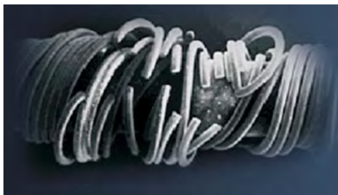
Figura 4: Aplastamiento subclavicular con rotura total de conductor
