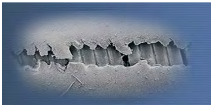
Figura 1: Abrasión de la silicona por roce subclavicular
