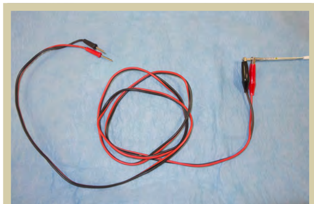
Figura 5. Adaptador para registro de señales endocavitarias a través de un cable de estimulación permanente de fijación activa.
